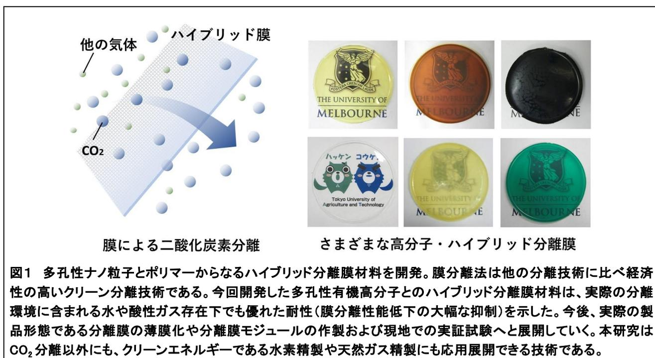
図1 多孔性ナノ粒子とポリマーからなるハイブリッド分離膜材料を開発。膜分離法は他の分離技術に比べ経済性の高いクリーン分離技術である。今回開発した多孔性有機高分子とのハイブリッド分離膜材料は、実際の分離環境に含まれる水や酸性ガス存在下でも優れた耐性（膜分離性能低下の大幅な抑制）を示した。今後、実際の製品形態である分離膜の薄膜化や分離膜モジュールの作製および現地での実証試験へと展開していく。本研究は CO<sub>2</sub> 分離以外にも、クリーンエネルギーである水素精製や天然ガス精製にも応用展開できる技術である。
